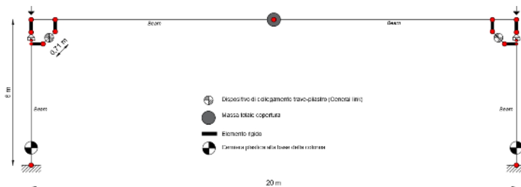
Figura 31. Modello a elementi finiti per l'analisi pushover (con dettaglio dei nodi).
