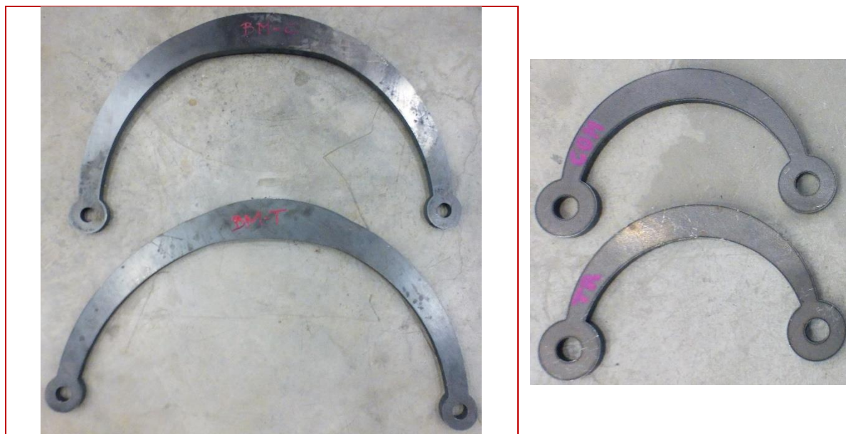
Figura 1. Immagine del dispositivo grande – Mezzaluna M1 (a sinistra) e di quello piccolo – Dissipatore 190 (a destra) prima delle prove di caratterizzazione.
