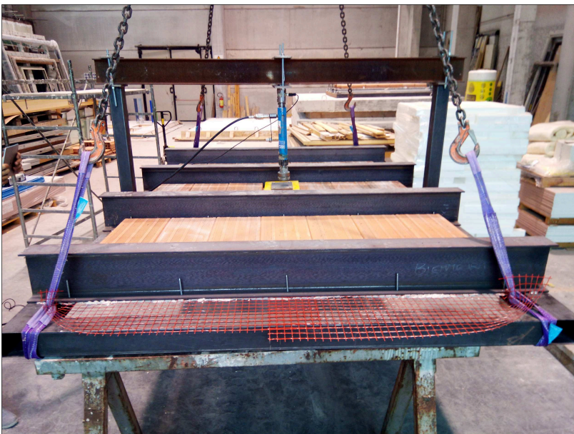
Fotografie della modalità di applicazione del carico
