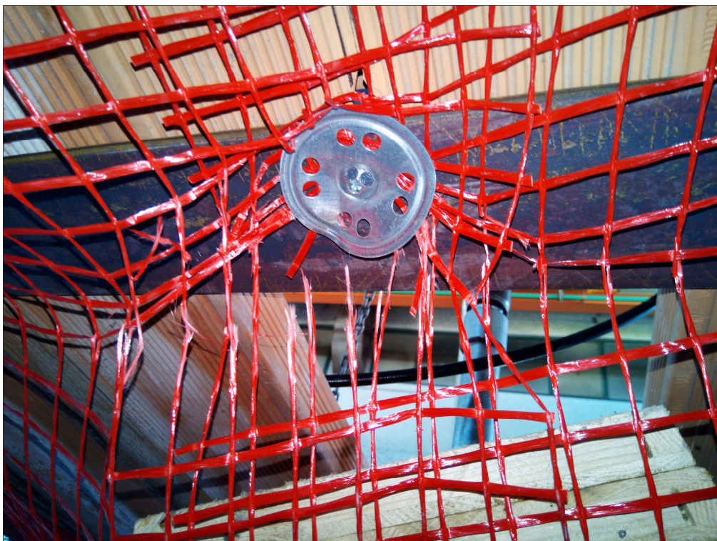
Fotografie del cedimento della rete dopo la prova sul sistema "S4"
