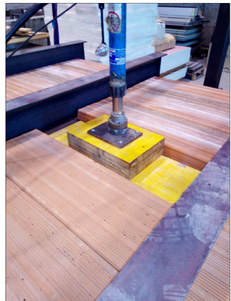
Fotografie della modalità di applicazione del carico
