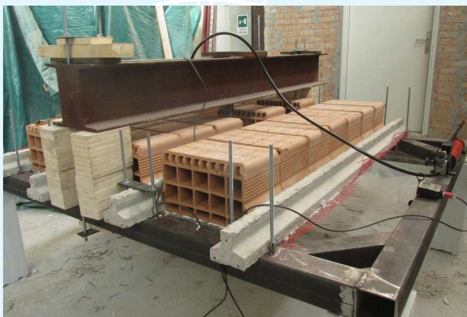
Fotografia della modalità di applicazione del carico nella prova n. 3.
