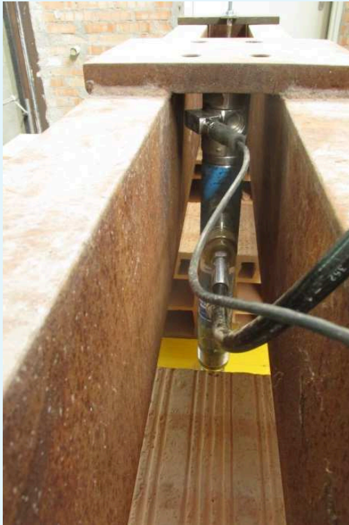
Fotografie della modalità di applicazione del carico nella prova n. 3.
