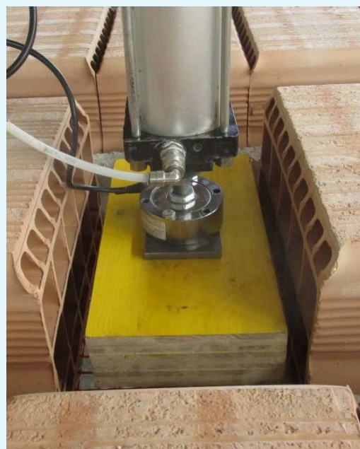
Fotografie della modalità di applicazione del carico nelle prove n. 1 e n. 2.
