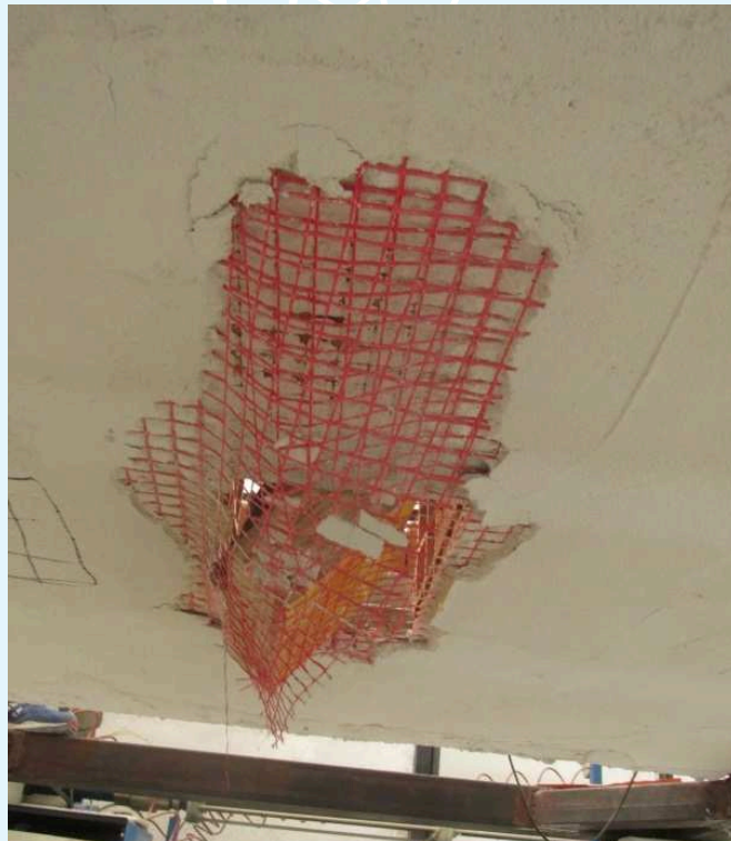
Fotografie della rottura nella prova n. 3.
