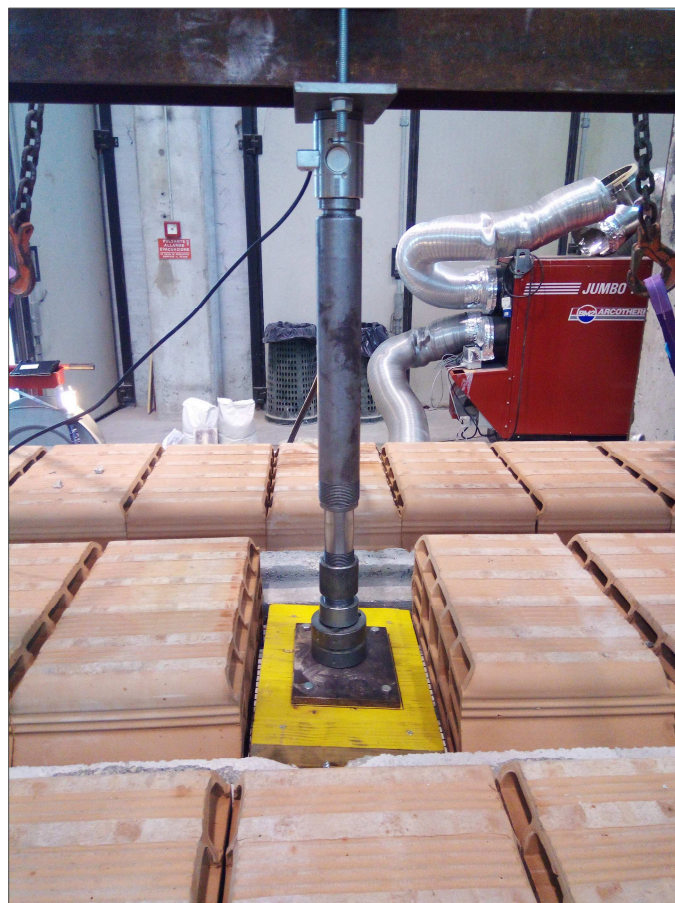
Particolare del sistema di spinta
