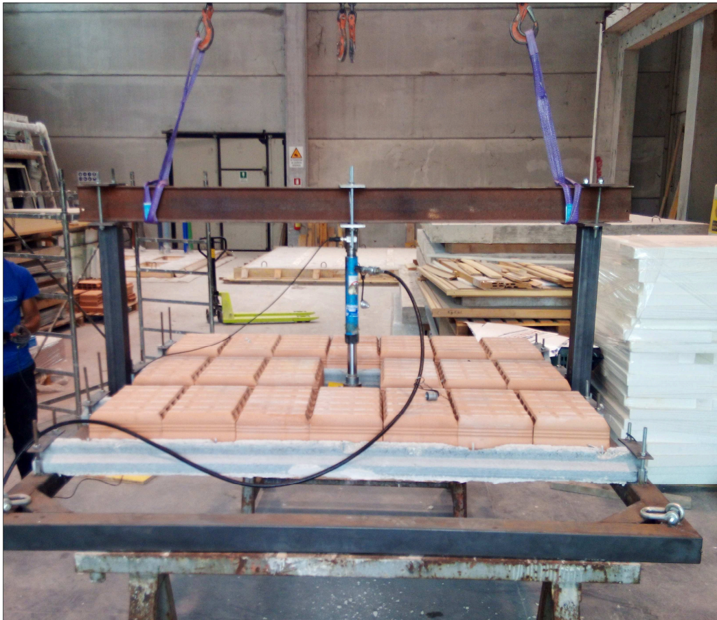
Fotografia della modalità di applicazione del carico
