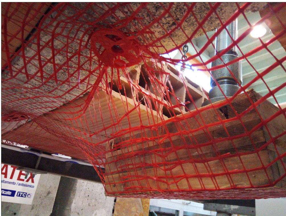
Fotografie del cedimento della rete dopo la prova sul sistema "S8"
