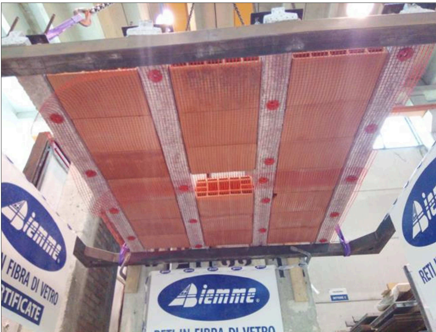
Fotografia dell'allestimento del sistema "S8" e particolare della vite "VACA" con flangia di fissaggio
